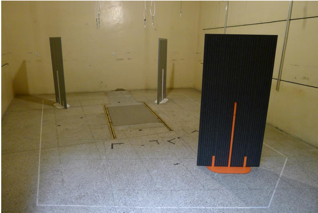
Rysunek 1 Widok próbki w trakcie badań w komorze pogłosowej
